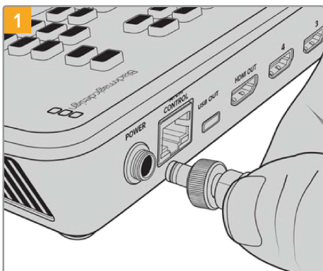
Stecken Sie das mitgelieferte Kabel in die Strombuchse am ATEM Mini
